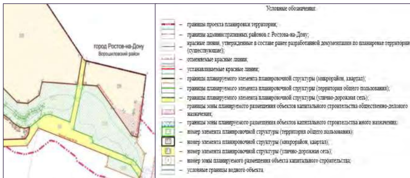
Рис. 2. Чертеж красных линий, элементов планировочной структуры и границ зон планируемого размещения объектов капитального строительства (участок на границе Ворошиловского и Октябрьского районов города Ростова-на-Дону)
